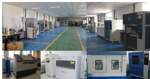
大型环试基地-各种环境腐蚀试验装置 40余台套（其中自主研发17台套）
